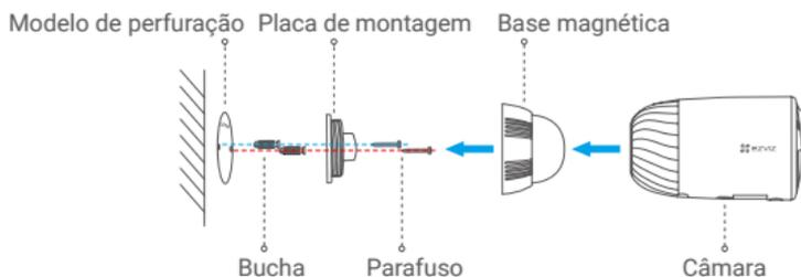
Fig.1 Montagem com base magnética
