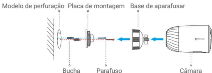
Fig.2 Montagem com base aparafusada
